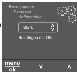
Abb.6: Beispiel: Display mit Bedientasten
